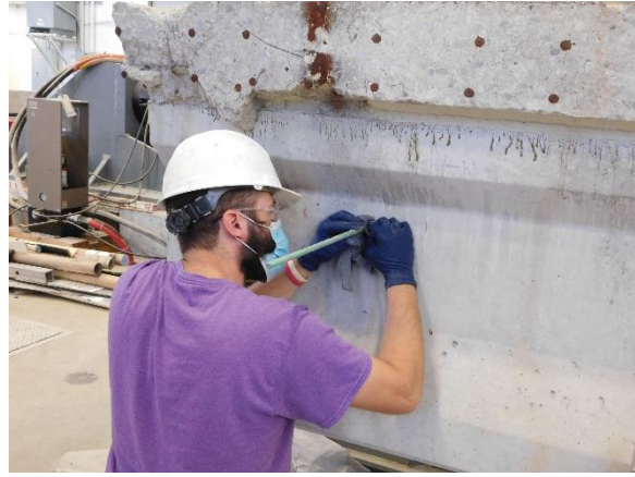
(d) No. 3 Bar Inserted Until Mark is Visible
