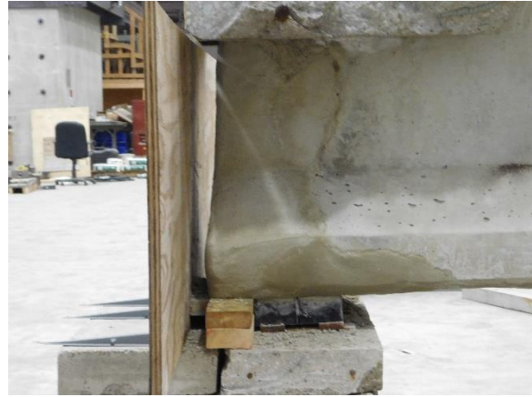
(d) Specimen After Mortar Repair
