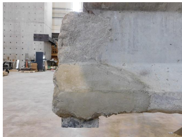
(d) Specimen After Mortar Repair
